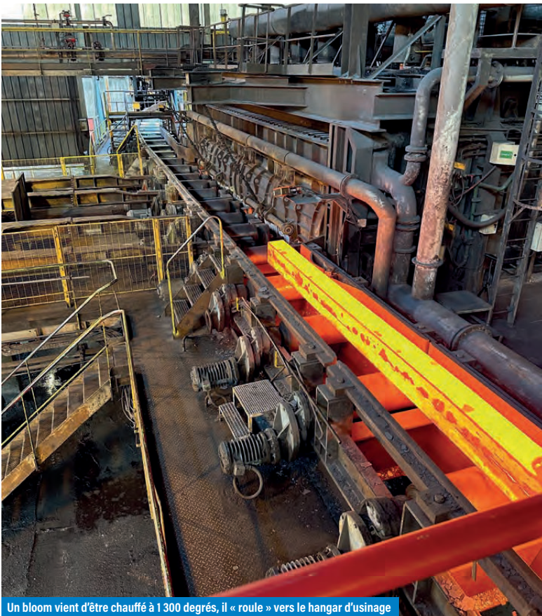
Un bloom vient d'être chauffé à 1 300 degrés, il « roule » vers le hangar d'usinage
